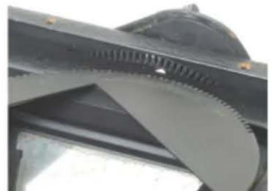
Anders als im Patent angegeben, wird bei meinem 6x9 Modell die Mattscheibenmaske ohne ein zwischengeschaltetes Zahnradgetriebe gedreht. Die Zahnkränze von Mattscheibenrückteil und Suchermaske greifen direkt ineinander.
